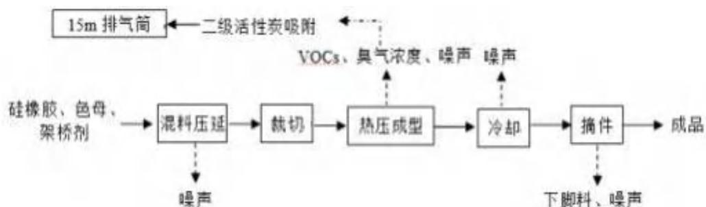
图 4.5-5 工艺流程及产污环节图
