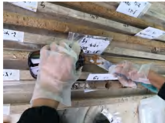
S1 土壤半挥发性有机物和重金属采样
