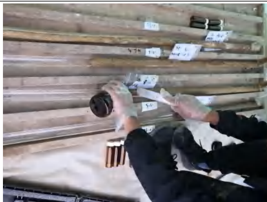
S3 土壤半挥发性有机物和重金属采样
