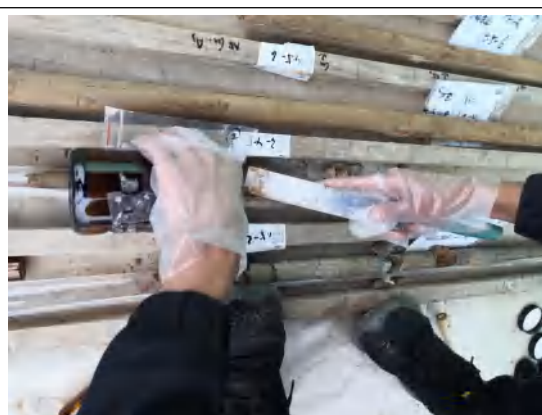
S2 土壤半挥发性有机物和重金属采样
