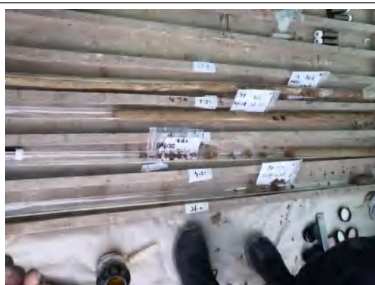
S3 土壤柱状样品
