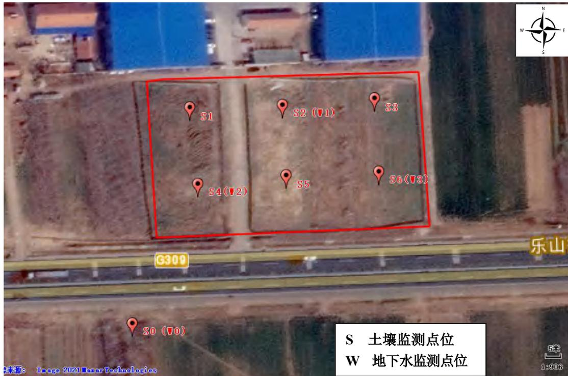
图 5.1-1 土壤、地下水监测点位布设示意图
