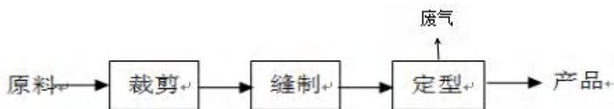
图 4.5-26 工艺流程图及产污环节
