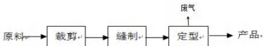
图 4.5-22 工艺流程图及产污环节
