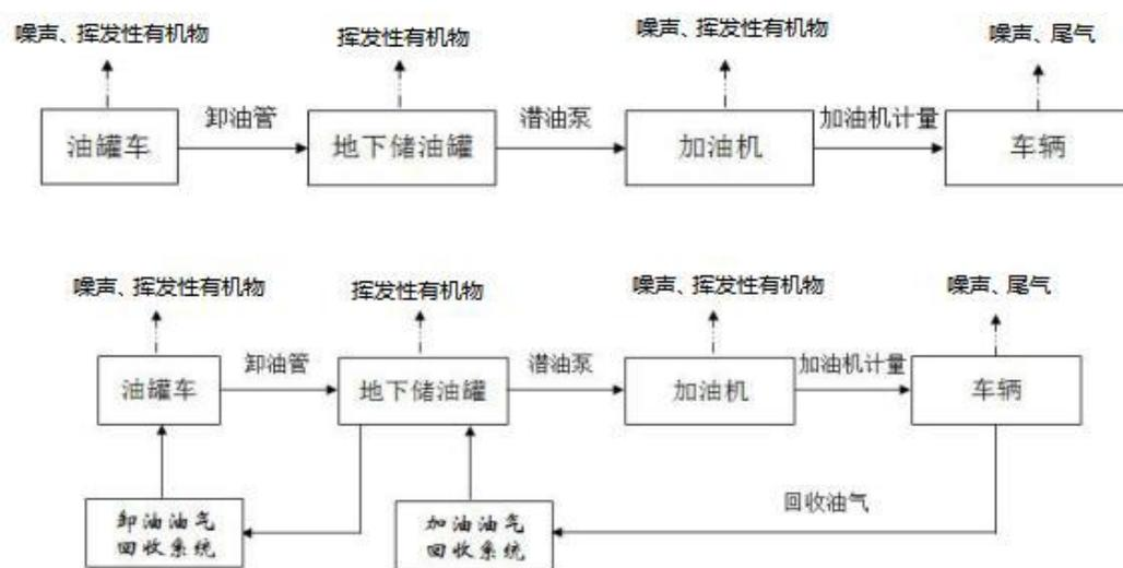
图 4.5-30 工艺流程图及产污环节
