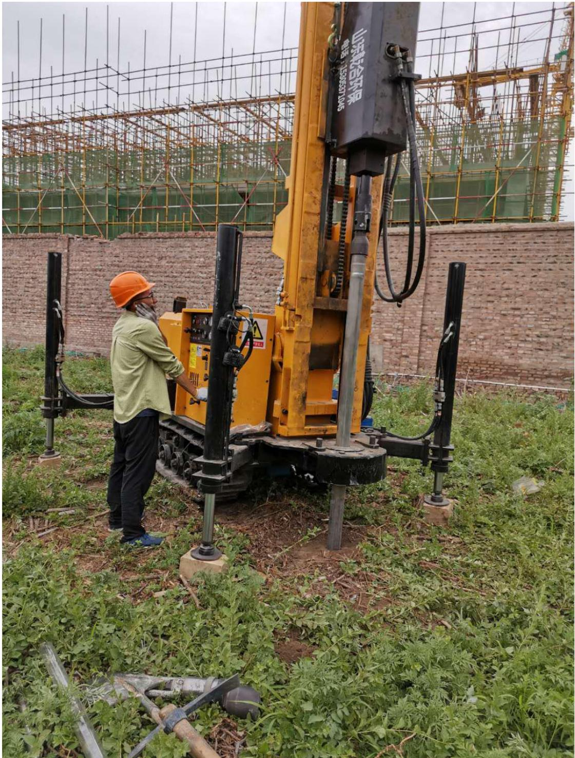
图 5.1-4 土壤取样设备照片
