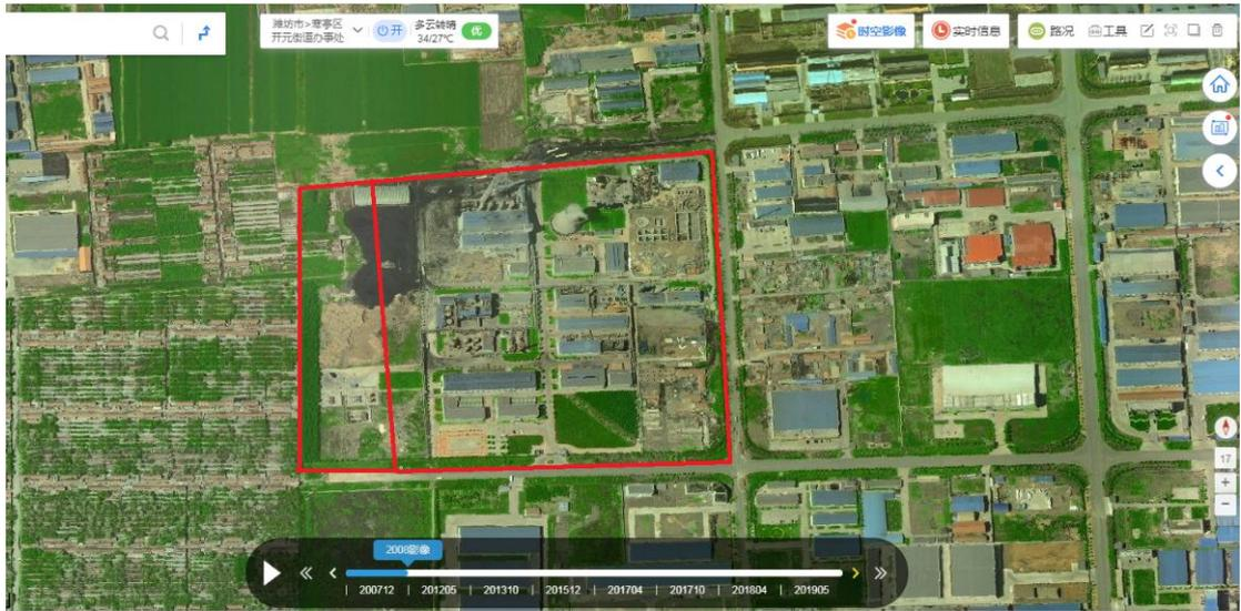
2008年：西边地块南侧为储罐区，中侧未开发利用，北侧偏东区域为煤场；东边区域已经建设完成，锅炉房、氰化钠车间、氰乙酸甲酯（乙酯）生产区、污水车间、办公楼等
